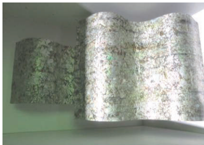
常温保存というメリットがあるアルミ付き紙パックだが、リサイクル過程で出ているアルミ残さ処理が課題となっている。テトラパックグループでは、ブラジルにおいてアルミ付き紙パックからポリエチレンとアルミを取り出し、屋根材へのリサイクルを実現している
