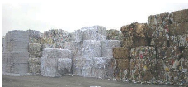
白物の古紙と、茶紙系の古紙をそれぞれ抄紙し、最終的に 2 枚を合わせて包装用紙を製造。紙パックは茶紙系の原料に使用されている
